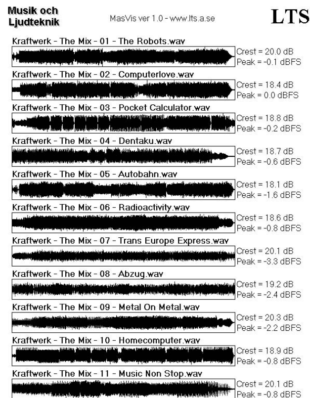
Figur 1. Översiktsgraferna i MasVis är lämpliga för att visa alla spåren på ett album. Vågformsgraferna innehåller båda kanalerna lagda ovanpå varandra för att spara plats. Till höger visas toppfaktor (crest) och toppvärde (peak). Man kan se att spåren på Madonnas produktion är väldigt starkt utstyrda. Vågformsgraferna ligger intill max utstyrning större delen av tiden och toppfaktorn ligger runt låga 10 dB. Vågformerna i Kraftwerks produktion har "luft" mellan vågformen och full utstyrning och toppfaktorerna ligger nära 20 dB. Vid en direkt jämförelse låter Kraftwerks skiva cirka 10 dB tytare, men den intelligenta lyssnaren drar förstås upp volymkontrollen med lika många dB när fonogrammens ljudkvaliteter ska jämföras.
